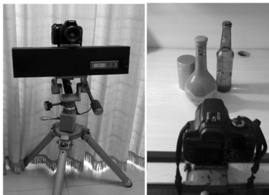
图 4 相机实拍图像采集系统
